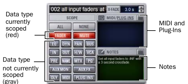
Botões Data Type Scope mostrando diferentes estados de abrangência de MIDI e plug-ins (vermelho)
