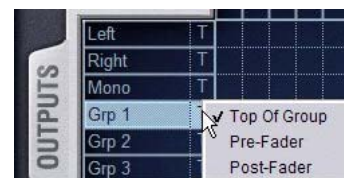
Selecionando um ponto de alimentação Direct Output na página Directs do Patchbay
