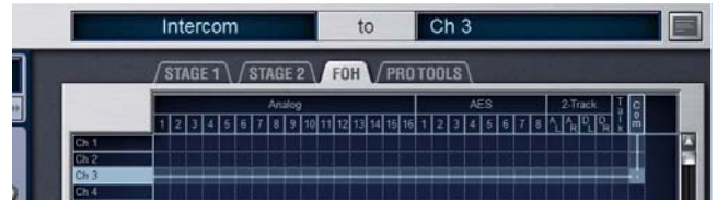
Endereçando a entrada Intercom no Patchbay
