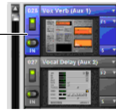
Slot de rack destacado indicando plug-in selecionado
